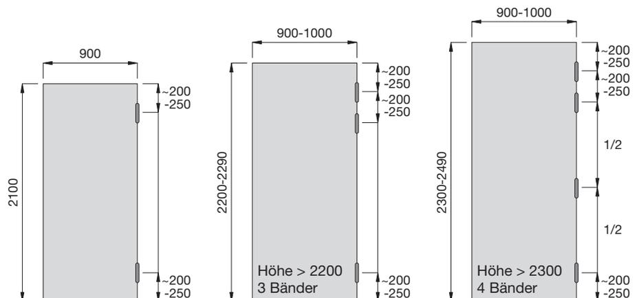
Für die Befestigung der Bandtaschen müssen Schrauben mit mind. Ø5x20mm verwendet werden.
