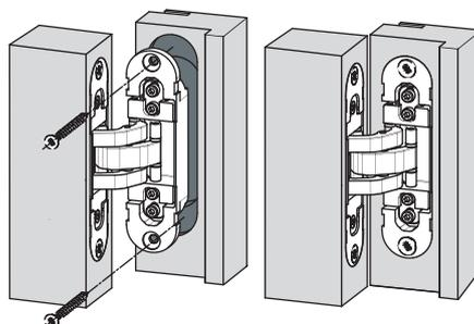
Das Türblatt in den Rahmen einsetzen, indem das Band-Rahmenteil (Tiefe 21 mm) in die Rahmenfräsung eingesetzt wird. Danach folgt die Befestigung der Bänder durch das Einschrauben von geeigneten Schrauben (mind. Ø5x20mm).
