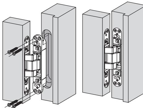
Das Türblatt in den Rahmen einsetzen, indem das Band-Rahmenteil (Tiefe 29,5 mm) in die Rahmenfräsung eingesetzt wird. Danach folgt die Befestigung der Bänder durch das Einschrauben von geeigneten Schrauben (mind. Ø5x20mm).
