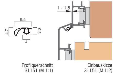
**Wichtige Hinweise für alle Aussendichtungen:** Das über das Fensterglas ablaufende Regenwasser kann grösstenteils über die Aussendichtung abgeleitet werden. Ein Anfüllen der Regenschiene mit Wasser, welches dann ins Fensterinnere eindringen kann, kann somit vermieden werden.
