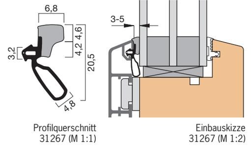
Profilquerschnitt 31267 (M 1:1)
