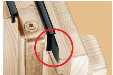
Um eine optimale Dichtigkeit zu erlangen, müssen die Eckteile bündig mit der Falzkante eingebaut werden.
