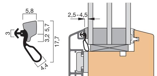
Profilquerschnitt 31303 (M 1:1)
