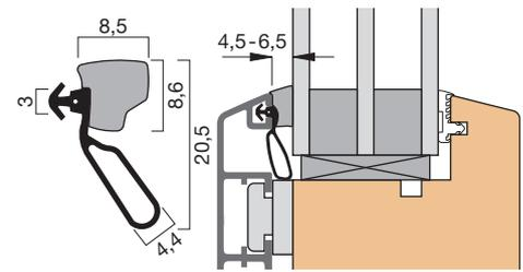
Profilquerschnitt 31209 (M 1:1)
