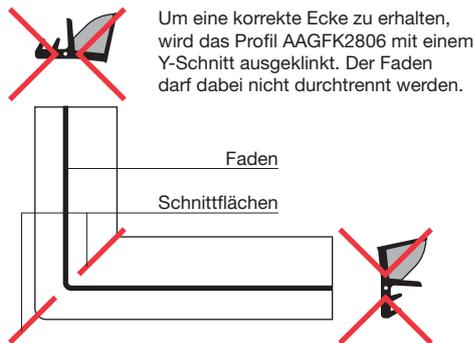
Um eine korrekte Ecke zu erhalten, wird das Profil AAGFK2806 mit einem Y-Schnitt ausgeklinkt. Der Faden darf dabei nicht durchtrennt werden.
