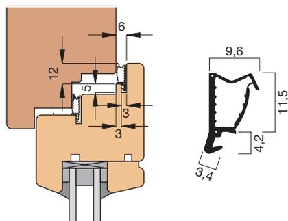
Einbauskizze 1041 im Überschlag (M 1:3)      Profilquerschnitt 1041 (M 1:1)
