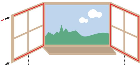
Das Rahmeneckteil AF2201E hält das Fenster an den kritischen Stellen dicht. Die Kombination ist mit einer Schlagregendichtheit von 9A nach der DIN EN 12208 zertifiziert.
