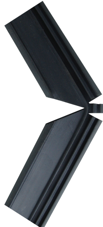
Ausklinken einer Rahmenecke - Y-Schnitt
