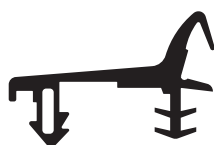
Przekrój profilu 3189 (M 1:1)
