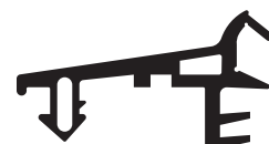
Przekrój profilu 31190 (M 1:1)
