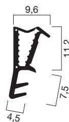
Przekrój profilu 1036 (M 1:1)
