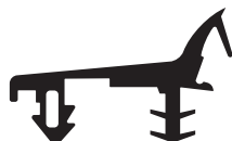
Przekrój profilu 31139 (M 1:1)
