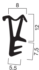
Przekrój profilu 2004 (M 1:1)
