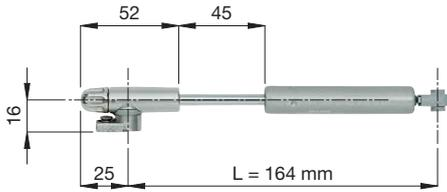
Ausführung mit SOFT-STOP: Der Klappen-Liftbeschlag KLB...164-O hebt die Türe bis zur maximalen Öffnung an. Der Hebevorgang wird anfangs zügig ausgeführt und kurz vor der vollständigen Öffnung sanft abgebremst.
