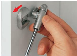
Einhängen des Lifterarmes in das Montageteil KLB-078, KLB-079 bzw. KLB-792. Durch Drehen des Montageteils kann die Schließkraft der Klappe erhöht werden.
