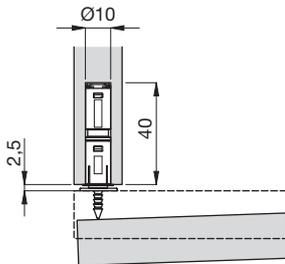
Eine Bohrung Ø10 mm mit mind. 40 mm Tiefe in den Oberboden, die Seite oder den Boden des Möbels bohren und den Schnäpper/Zusatzmagneten in die Bohrung einsetzen. Das Verschlussstück mittig am magnetischen Schnäpper positionieren und die Türe vorsichtig schließen. Die Spitze des Verschlussstücks zeigt die richtige Montageposition. Die Türe wieder öffnen und das Verschlussstück eindrücken.
