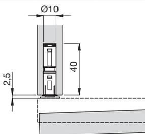
Eine Bohrung Ø10 mm mit mind. 40 mm Tiefe in den Oberboden, die Seite oder den Boden des Möbels bohren und den Schnäpper/Zusatzmagneten in die Bohrung einsetzen. Das Verschlussstück mittig am magnetischen Schnäpper positionieren und die Schutzfolie vom Klebeband abziehen. Die Türe vorsichtig schließen. Die Türe wieder öffnen und das Verschlussstück festdrücken.
