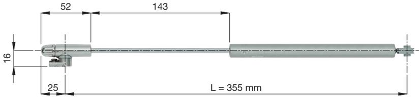
Ausführung mit SOFT-STOP: Der Klappen-Liftbeschlag KLB...355-O hebt die Türe bis zur maximalen Öffnung an. Der Hebevorgang wird anfangs zügig ausgeführt und kurz vor der vollständigen Öffnung sanft abgebremst.
