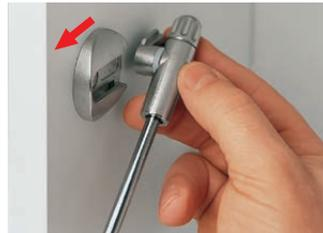
Einhängen des Lifterarmes in das Montageteil KLB-078, KLB-079 bzw. KLB-792. Durch Drehen des Montageteils kann die Schließkraft der Klappe erhöht werden.
