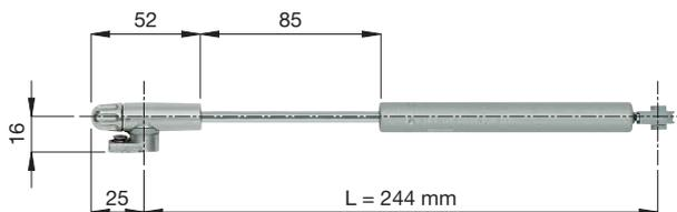
Ausführung mit SOFT-STOP: Der Klappen-Liftbeschlag KLB...244-O hebt die Türe bis zur maximalen Öffnung an. Der Hebevorgang wird anfangs zügig ausgeführt und kurz vor der vollständigen Öffnung sanft abgebremst.
