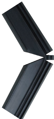
Ausklinken einer Rahmenecke - Y-Schnitt
