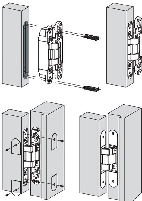
Das Bandteil mit der Aufschrift "door" (Tiefe 35,5 mm) in das Türblatt einsetzen, wobei die korrekte Öffnungsrichtung beachtet werden muss. Es folgt die Befestigung der Bänder durch das Einschrauben von geeigneten Schrauben (mind. Ø5x20mm).
