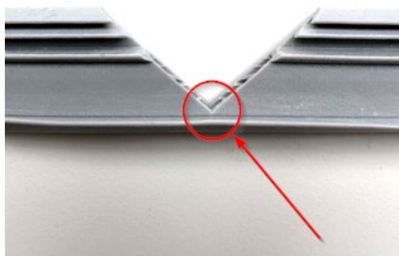
Idealne cięcie dla uzyskania elementu narożnego
