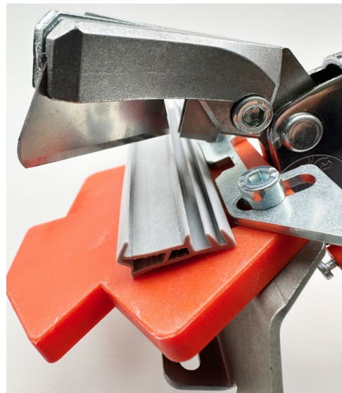
Ogranicznik głębokości cięcia Y
