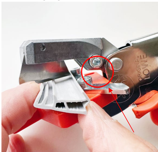
Przechylenie uszczelki podczas wykrawania
