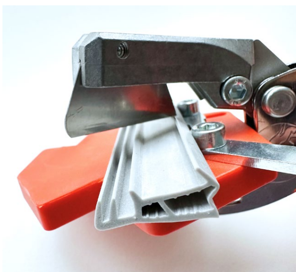
Ogranicznik głębokości cięcia V
