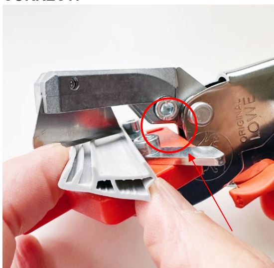
Incliner le joint lors de l'encochage
