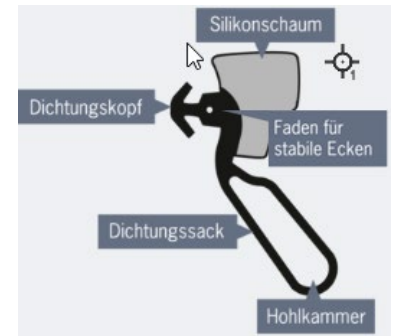
Beispiel Trockenverglasungs- dichtung SGFK31207
