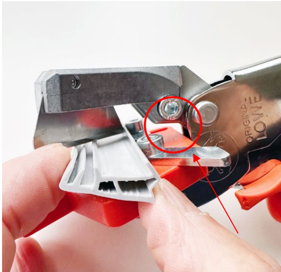
Ankippen der Dichtung beim Ausklinken
